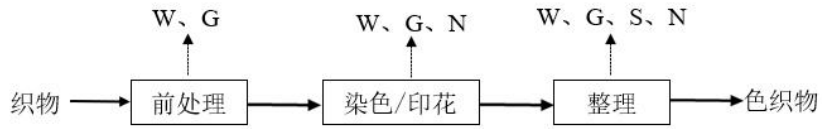
图 A.5 典型染整工艺流程及主要产污环节
