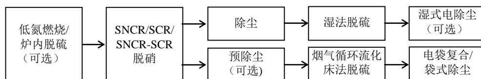
图 1 煤粉锅炉及循环流化床锅炉烟气治理工艺流程
