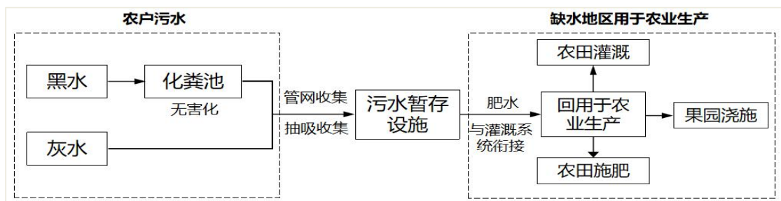
图 5 输送到农田浇灌系统浇施示意图
